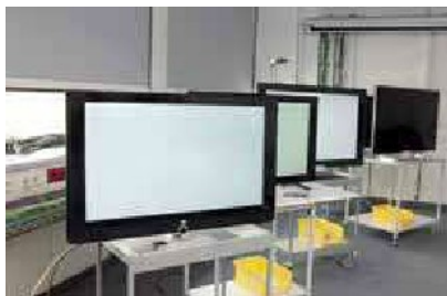
Televizory připravené na měření rovnoměrnosti podsvícení.
